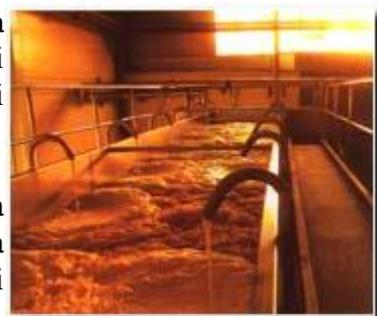
Quando la radichetta raggiunge grosso modo i due terzi della lunghezza del chicco, il malto è pronto per l'essiccazione o la torrefazione, il cui scopo è quello di arrestare il processo di germinazione.
